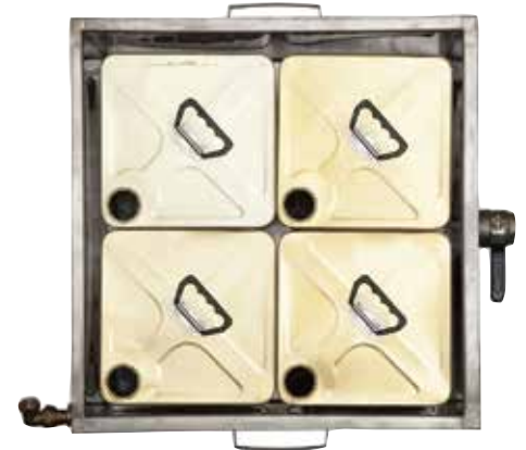
4 Tenekelik Bal Eritme Kazanı Çift cidarlı, 0.5 mm 304 kalite paslanmaz çelik gövde ve aksesuarlar 02138
